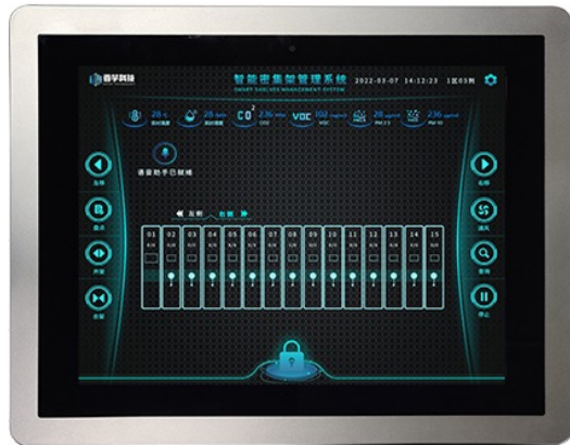
固定列： 国产瑞芯微RK3399芯片 15寸多点触摸电容屏 统信智能终端操作系统
